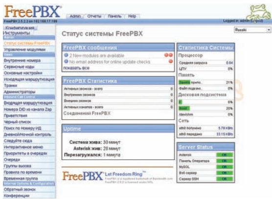
ИНТЕРФЕЙС FREEPBX ПОЗВОЛЯЕТ В УДОБНОЙ ФОРМЕ НАСТРОИТЬ БОЛЬШИНСТВО ПАРАМЕТРОВ ASTERISK
